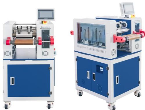
MSK-BPC-DF200 是一款 3 辊连续辊轧机，3 个辊的转速可独立设置，用于锂电池电极制备，基底也用各种金属箔材，如铜，不锈钢，镍合金等。3 个轧辊的转速可独立调控，最大压力可达 8T。
