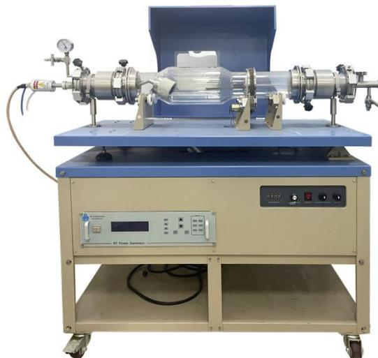
旋转粉末磁控溅射仪是通过粉末在溅射腔室内的旋转,以达到粉末表面均匀包裹的效果。腔室可旋转、倾斜,能快速出料。是制作各种金属薄膜理想的镀膜设备,可选配各种金属靶材、氧化物靶材。
